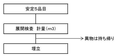
※廃棄物3.00m埋立後、0.75mの覆土を施工する「サンドイッチ方式」
